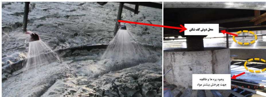
شکل ۷- تغییرات انجام شده برای از بین بردن کف در چاهک خوراک دهی
