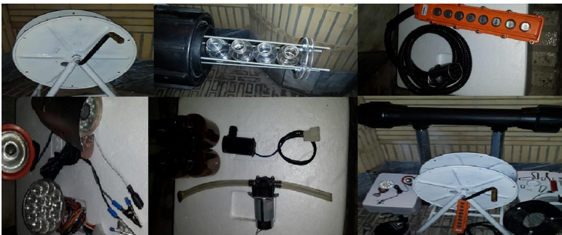
شکل ۱- ربات بازرسی خط لوله فاضلاب، مجهز به سیستم تصویر برداری و نمونه گیری
